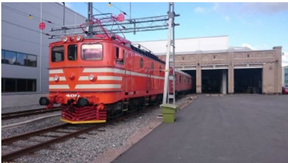
En sk. gudrunbrygga med lok som har främre strömavtagare uppfälld.
