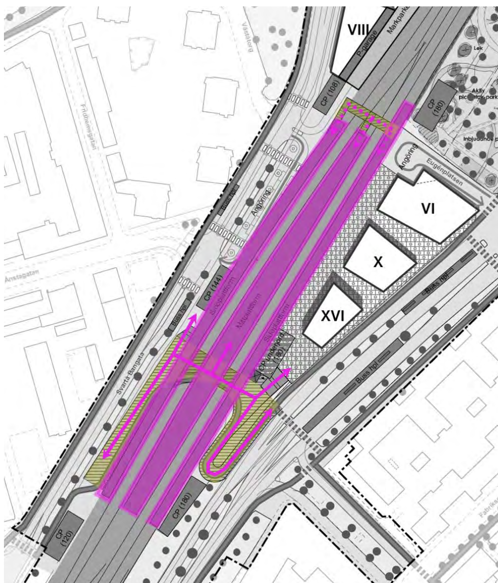
Figur 47. Principutformning för plattformar och spår
