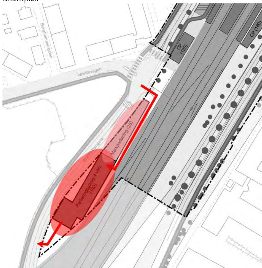
Figur 61. Förslag på allmänt parkeringsgarage med plats för upp till 180 bilar och en mindre markparkering med upp till 25 platser.
