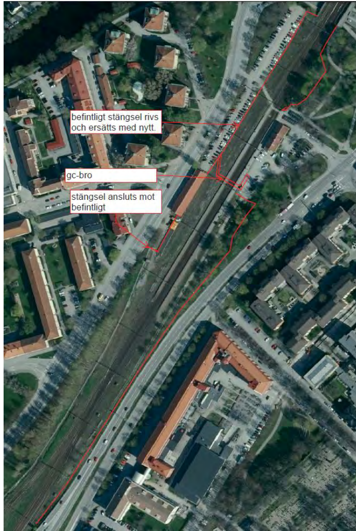
Figur 35. Stängsling av järnvägen och placering av tillfällig gångbro, FU 2017
