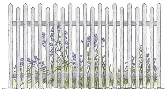
Staket är inte bygglovspliktiga. Ett staket är maximalt 1,1 meter högt. Det kan få vara högre utan att kräva bygglov, men då måste det vara genomsiktigt.
