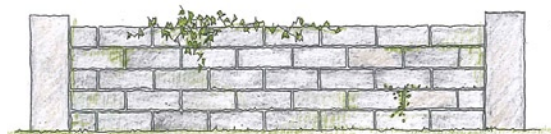
Enligt plan- och bygglagen krävs bygglov för murar. I Örebro kommun krävs bygglov om de är högre än 0,5 meter.
