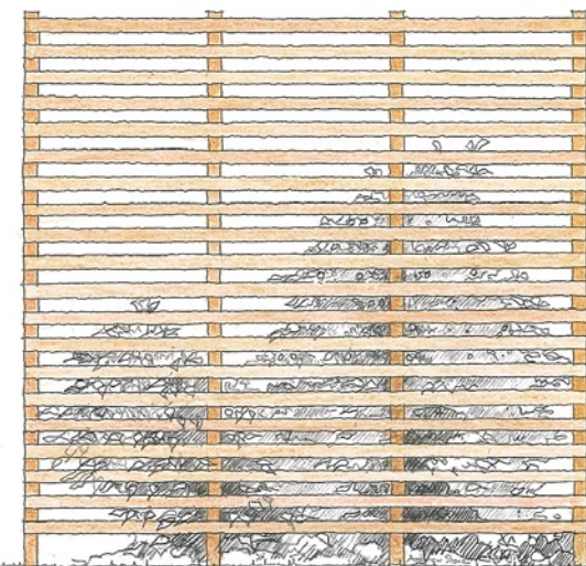
Det här insynsskyddet är bygglovspliktigt, eftersom det både är ogenomsiktig och högre än 1,1 meter. Men i vissa fall krävs inte bygglov för en sådan här lösning. Se nästa sida!
