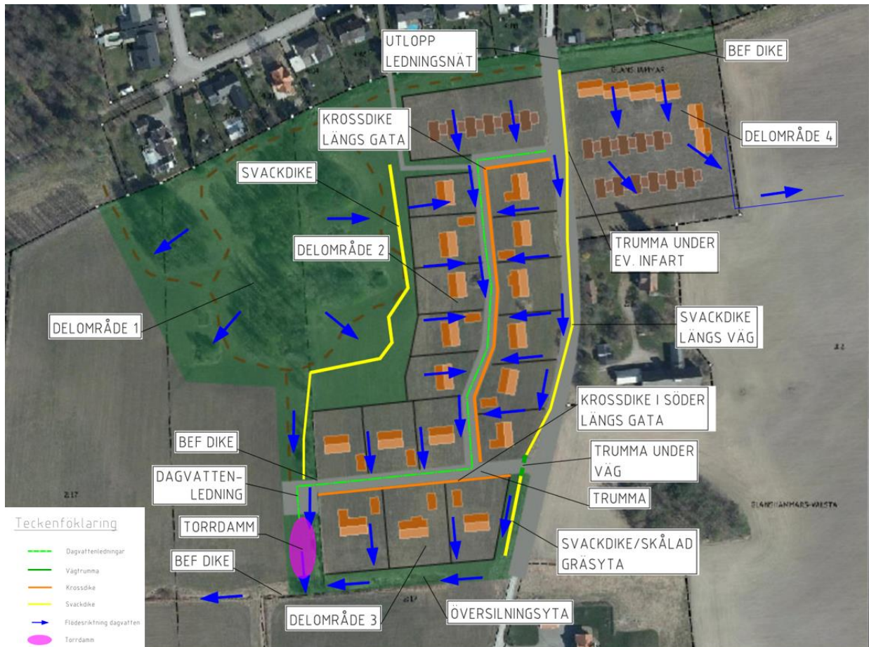
Figur 23. Förslag på dagvattenhantering, flödesriktning markerat med blåa pilar, nya krossdiken i orange, svackdiken i gult, torrdamm i lila och dagvattenledningar i ljusgrön-streckad linje.
