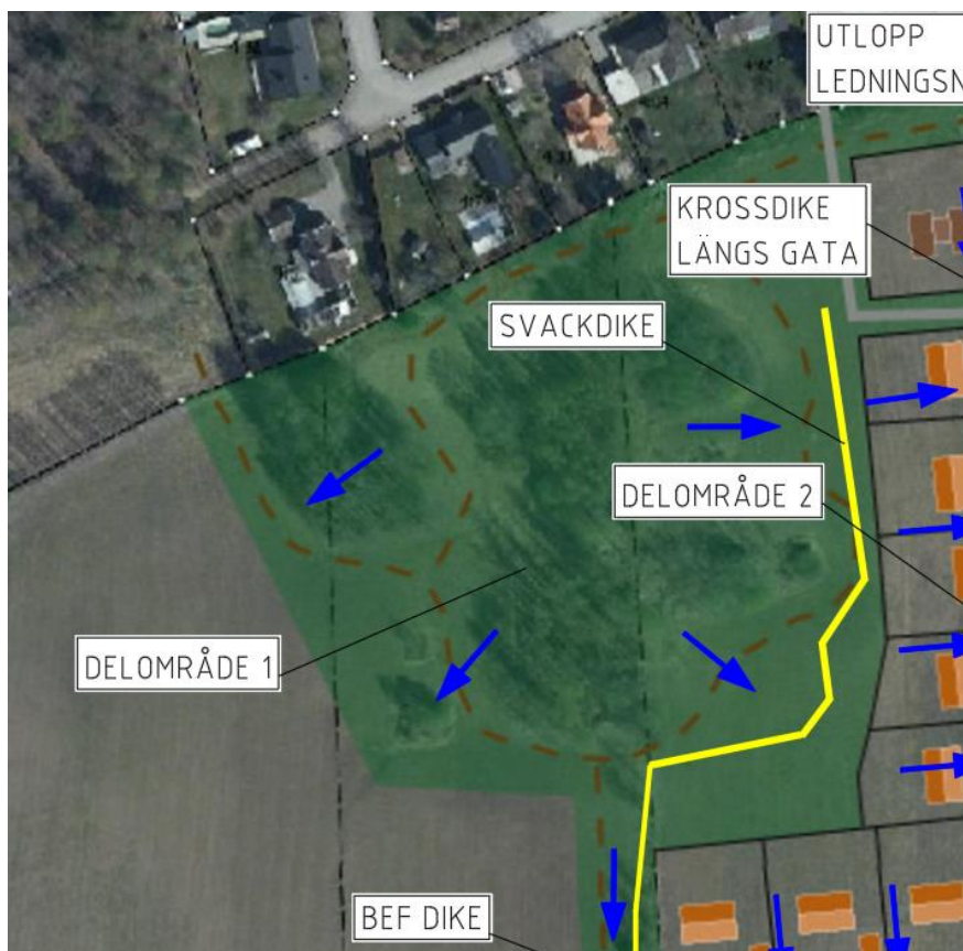
Figur 24. Förslag på dagvattenhantering inom delområde 1. Gul linje visar en schematisk placering för framtida svackdiken.
