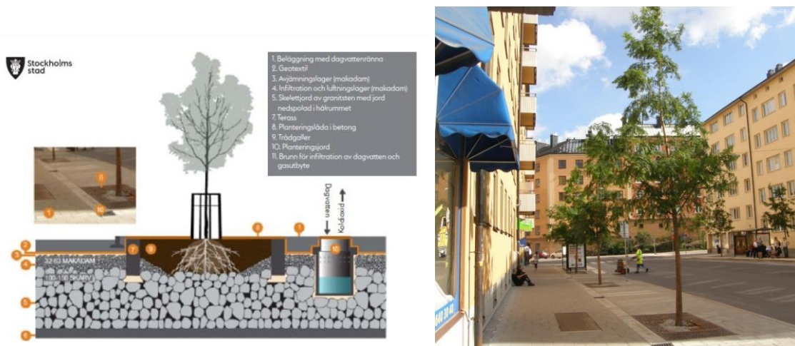
Figur 2. Principskiss för skelettjord (t.v.). Exempel på träd i skelettjord (t.h.). (Foto Stockholm Vatten och Avfall)
