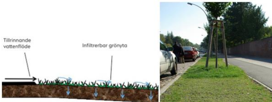
Figur 4. Principskiss för en infiltrerbar grönyta till vänster, exempel på en nedsänkt grönyta till höger. Illustration av WRS.
