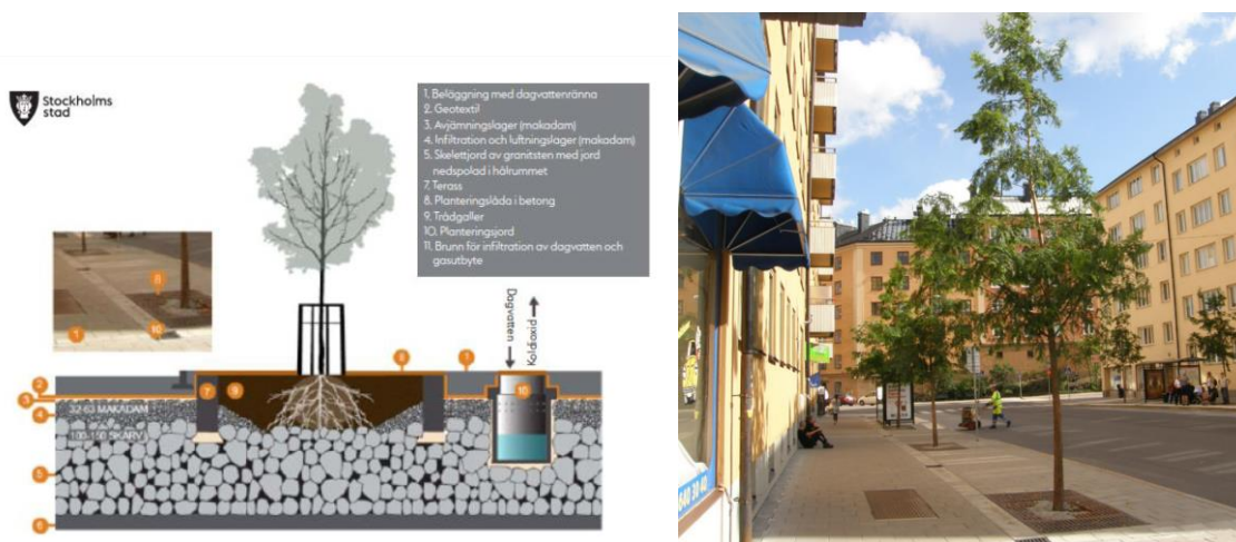
Figur 2. Principskiss för skelettjord (t.v.). Exempel på träd i skelettjord (t.h.). (Foto Stockholm Vatten och Avfall)
