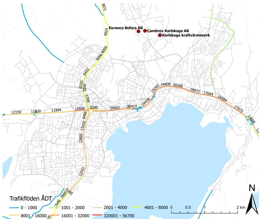
Figur 8. Verksamheter med utsläpp till luft samt trafikflöden som årsdygnstrafik (ÅDT) på det statliga vägnätet i Karlskoga tätort.
