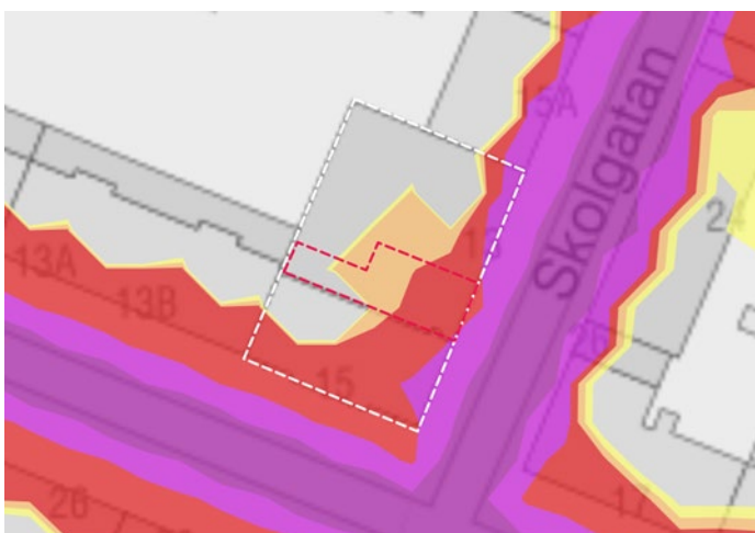
Bilden illustrerar vilka förutsättningar som finns vad gäller den maximala ljudnivån. Terrassen är inringat med röd streckad linje och planområdet för detaljplanen är inringat med vit streckad linje.
