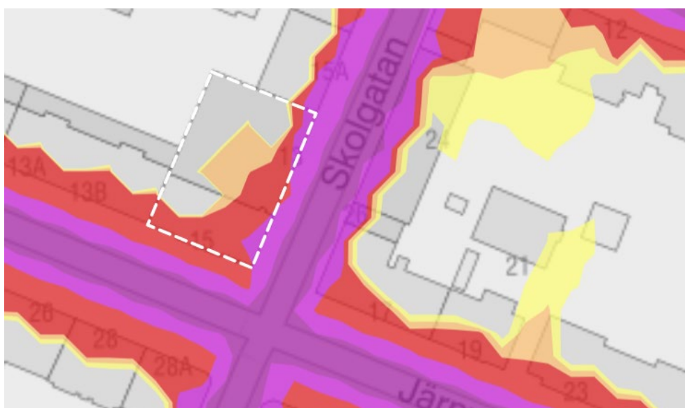
Bild som illustrerar Örebro kommuns bullerkartering från 2022 vid planområdet Fabriken 14. Bilden illustrerar maximal ljudnivå där den gula färgen betyder 65–70 dBA, den orange färgen 70-75 dBA, den röda färgen 75-80 dBA och den lila färgen 80-85 dBA. Planområdet Fabriken 14 är inringat med vit streckad linje.
