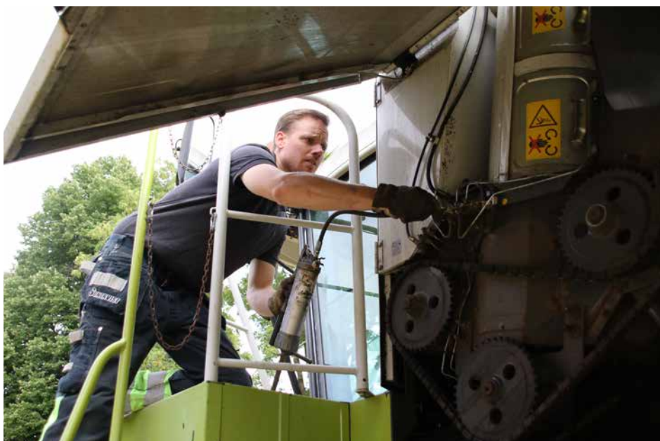
Innan Karl Sundkvist kan ge sig ut och tröska för dagen behöver det smörjas och fixas. Att kunna serva maskinerna är ett måste.
