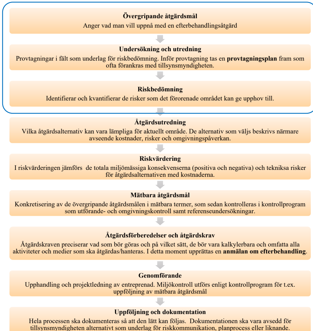
Figur 2.1 Schematisk beskrivning av utrednings- och efterbehandlingsprocessen, där blåmarkering anger de moment som det aktuella objektet har utfört.
