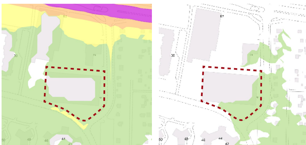
Ekvivalenta bullernivåer från väg- (vänster) och tågtrafik (höger). Grön = 50-54 dBA, Gul = 55-59 dBA, Orange = 60-64 dBA, Röd = 65-69 dBA, Lila = 70-74 dBA. Planområdet är schematiskt markerat med röd streckad linje.
