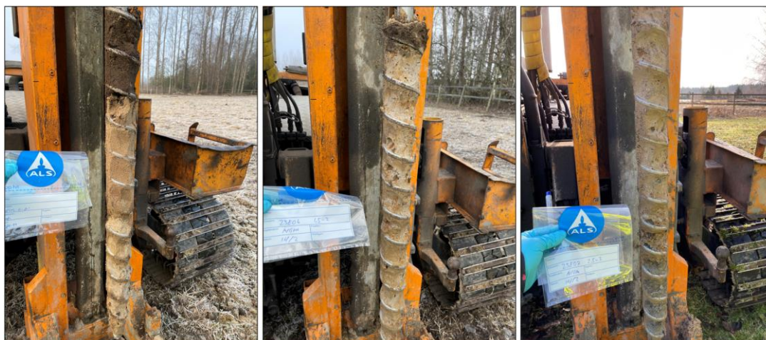
Figur 10. Bilder från provtagning med skruvborr. Bild till vänster visar första metern för punkt 23E09 (0–1 meter). Bild i mitten visar den andra metern för punkt 23E06 (1–2 meter). Höger bild visar den fjärde metern för punkt 23E07 (2–3 meter).
