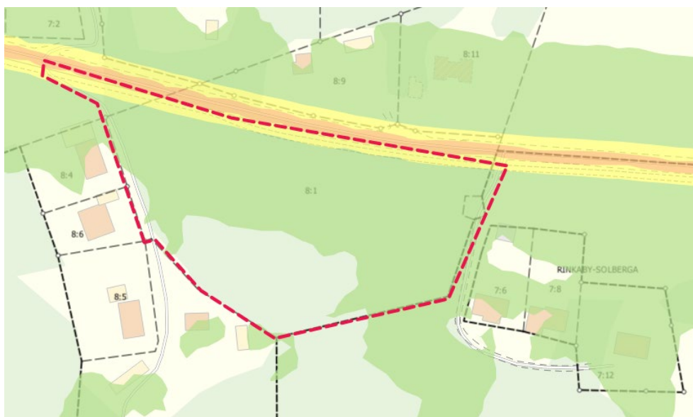
Utdrag ur Örebro kommuns bullerkartering 2022 för Ekvivalent ljudnivå (dBA) för kommunal och statlig vägtrafik. Ekvivalent ljudnivå; Grönt 50–54 dBA, Gul 55-59 dBA, Orange 60-64 dBA. Planområdet är schematiskt inringat med röd streckad linje.
