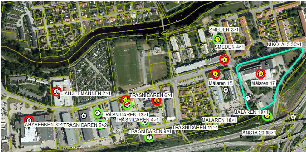
Figur 3.2. Flygfoto över delar av Önsros industriområde. Fastigheten Mälaren 17 har ungefärligt markerats med turkost. I figuren visas objekt som identifierats som potentiellt förorenade enligt Länsstyrelsens register EBH-stödet. Markeringen visar om objektet indelats i riskklass 1, 2 eller 3. Vita objekt, märkta med E, har identifierats men ej indelats i någon riskklass. Objekt som ringats in med rött har nyttjat, eller misstänks, ha nyttjat klorerade lösningsmedel. Objekt inringat med grönt antas ej ha nyttjat klorerade lösningsmedel.
