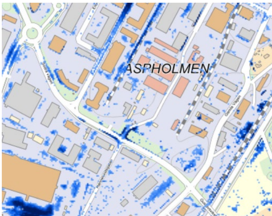
Kartbild över översvämningsituationen i de södra delarna av planområdet. Mörkare blå färg illustrerar en djupare vattennivå vid ett så kallat 100-årsregn.
