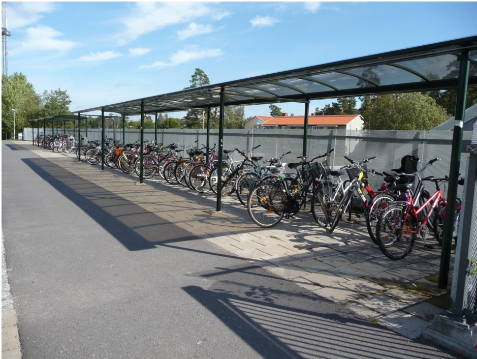
Figur 5. Gör cykelparkeringar attraktiva genom placering nära målpunkten, möjlighet att låsa fast ram, väderskydd och belysning. Exempel från Ösmo station i Nynäshamns kommun
