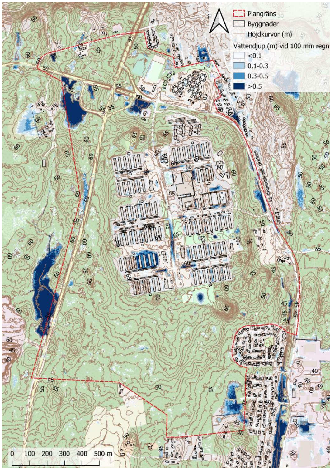
Figur 14. Områden som riskeras att ställas under vatten vid 100 mm nederbörd baserat från höjddata i SCALGO (Scalگو, 2020).
