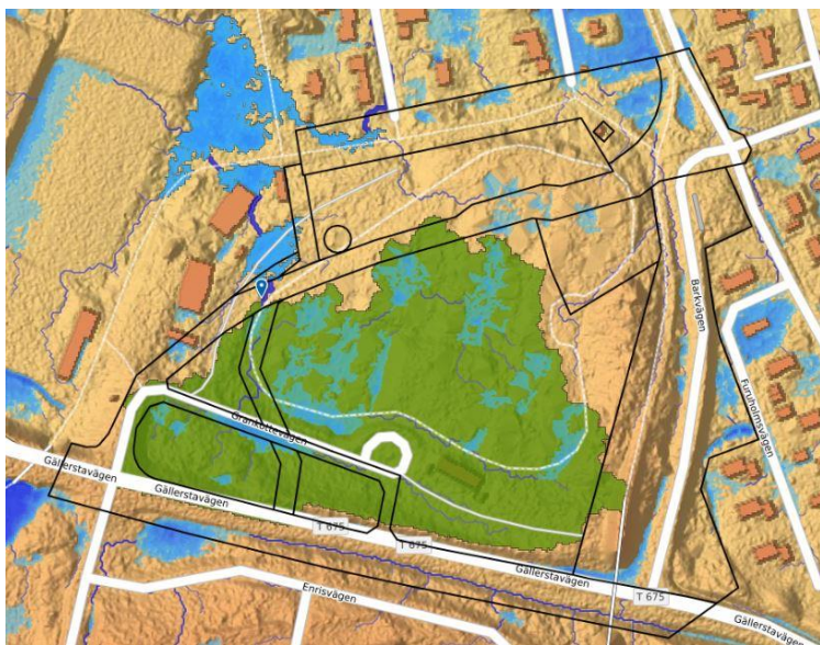
Figur 24. Yta som avleds via den västra flödesvägen som korsar ny BRT-väg markeras i grönt. (Scalگو Live, 2021)
